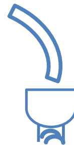
نمونه صحیح نصب لوله خروجی فاضلاب
